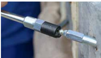
DESOI Snappy auf den Kegelnippel schieben, Sicherungssteg unten | Pousser le DESOI Snappy sur le nipple à tête ronde (barre de sécurité en bas)
